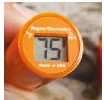
RH-test (relativna vlažnost betonabetona)
