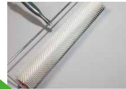
14. 4. Odmah nakon gletanja materijal treba odzračiti valjkom sa šiljcima. Cipele s šiljcima moraju se nositi tijekom nanošenja dok se hoda preko svježeg materijala
