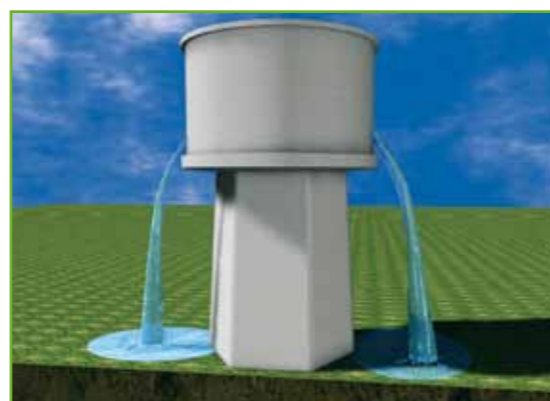
Gefüllte Wassertanks sind oft nicht von innen zugänglich, um dort eine Abdichtung aufzubringen. Um den Tank ununterbrochen weiter nutzen zu können, kann die Abdichtung von außen als Negativabdichtung aufgebracht werden.
