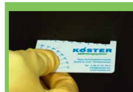
Mjerač debljine se utisne u svježi sloj
