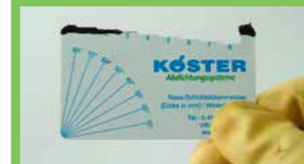
- kad se izvuče očitava se debljina
